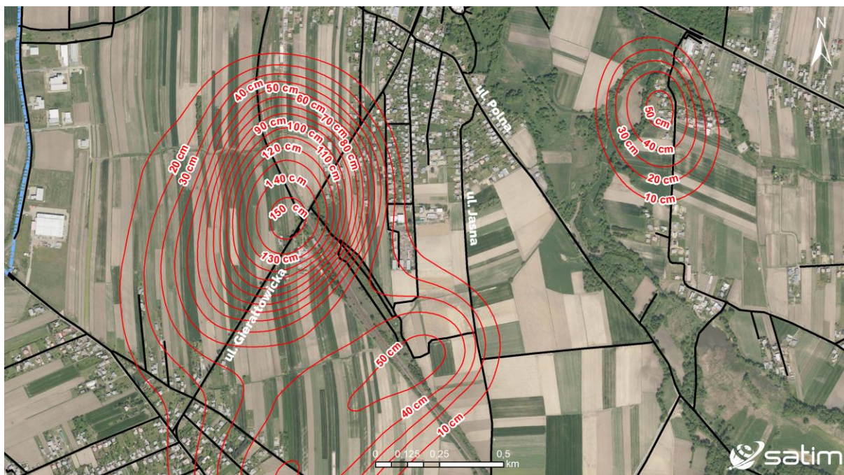
Ryc. 3 - Mapa pionowych przemieszczeń terenu – obniżenia w formie izolinii (Przyszowice). Izolinie oddalone od siebie o stałą wartość 10 cm cięcia poziomowego.
